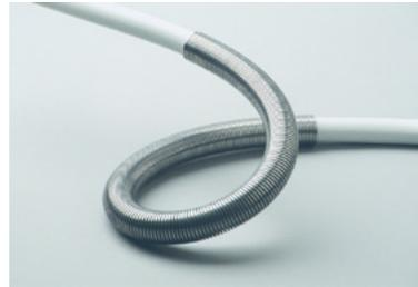
WIROFLEX kann ohne den Einsatz eines Fittings, einfach mit Biegefedern in die gewünschte Form gebogen werden, ohne dass es sich zurückbiegt. Die Außen-Biegefeder wird über das Rohr gesteckt und kann so an jeder Stelle des Rohres eingesetzt werden.
