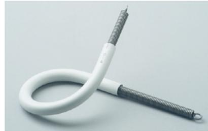
Mit der Innen-Biegefeder, die in das Rohrende gesteckt wird, lassen sich enge Winkel formen. Der Einsatz von Fittings ist nur für sehr enge Radien zu empfehlen.
